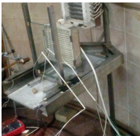
Рисунок 12 – Стенд для определения коэффициентов отражательной, поглощательной и пропускающей способности закаленного стекла
